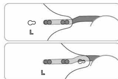
取付穴の位置をずらすことで、フェイスシールドと顔の距離を調整できます。(2段階)
